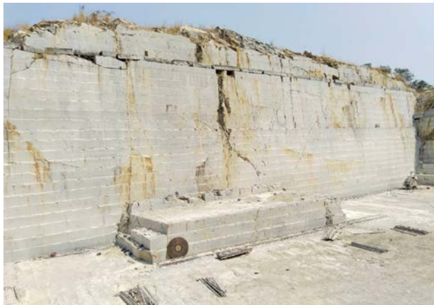
รูปที่ 2-1 การผลิตแร่โดยใช้เลื่อยยนต์และการเจาะแบ่งด้วยลิ้ม
