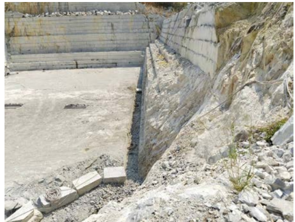
รูปที่ 2-2 ลักษณะการเปิดเหมืองแบบขั้นบันได
